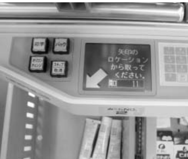
写真 - 6 作業内容や行き先を表示するカラーグラフィック・メインディスプレイ。矢印で作業工程を明確に指示
