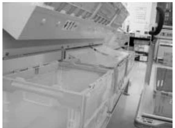
写真 - 7 シャッター付仕分け間口。手前が開いている状態で、直感的な作業を実現する
