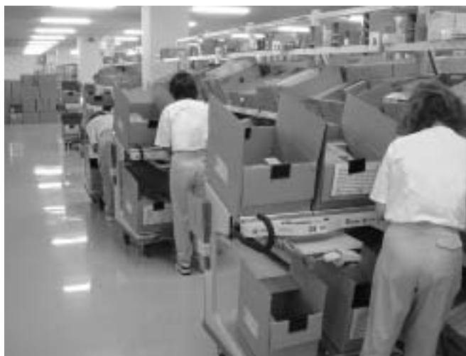
写真-5 摘み取り方式。仕分け先ごとの容器を積み、並べられた商品から摘み取る
