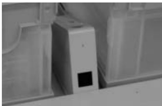
写真 - 8 間口には赤外通信装置が設置され、常時カートと通信を行う
